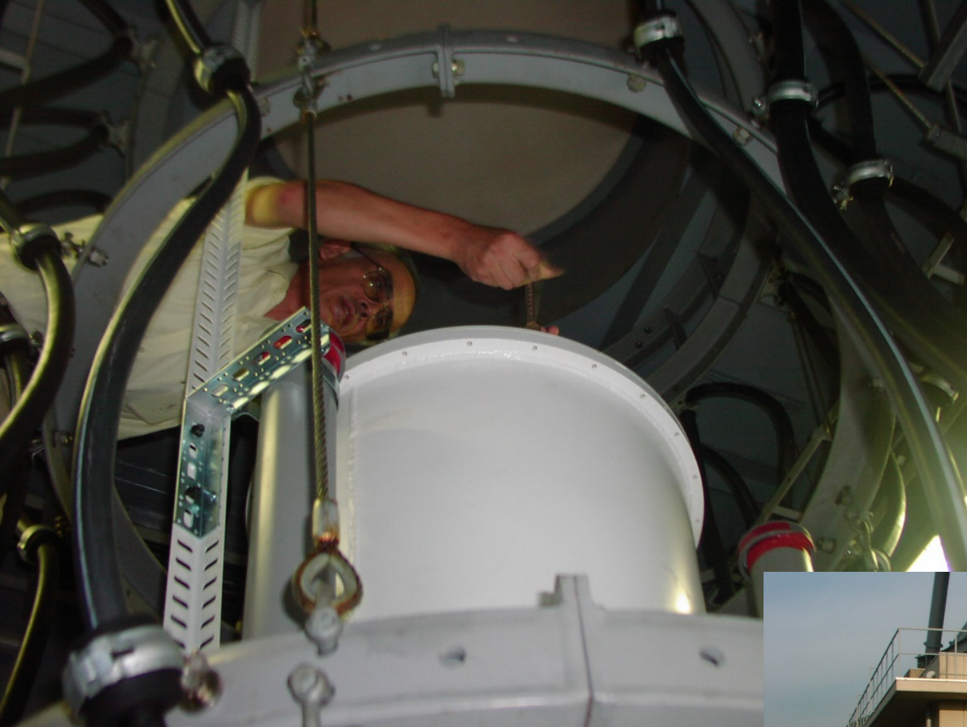
ホーンカバーの空気漏れ実験(2003年夏)
