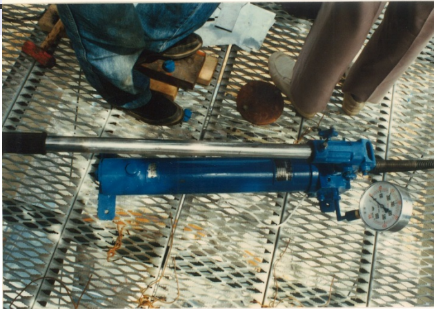
油圧ポンプの加圧部
