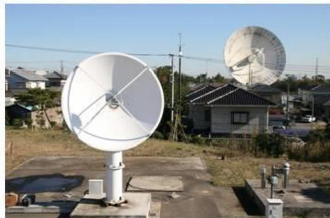
図2 2007年12月5日に実施したフリンジテストの様子。手前が新フロントエンドを搭載したCARAVAN2400、後方が34mアンテナ。
