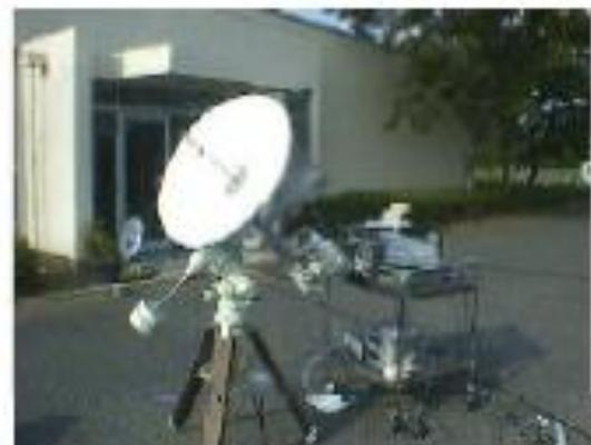
図1: キャラバン電波望遠鏡。小型赤道儀にコリメーション用の光学望遠鏡と同架されている。
