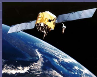
GPS衛星: 衛星には原子時計が積まれ、時刻と衛星位置を地表にむけて送信している
