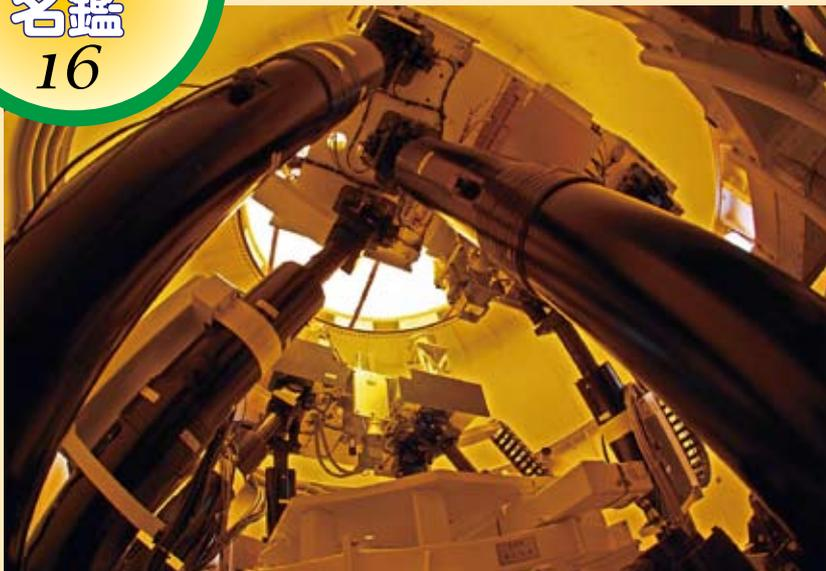
● VERA のアンテナのカセグレン焦点部にあるのが、2つの天体を同時に観測するための2ビーム受信機と視野回転装置です。2台の受信機が、6本のジャッキで支えられた2つのスチュアートプラットホーム上にそれぞれ搭載されています。6本のジャッキの長さを変化させることで、プラットホームを焦点面上に沿って、任意の場所に動かすことができます。これによって VERA は 0.32 度から 2.2 度までの離角を持つ 2 つの天体を同時に観測することができます。さらに、プラットホームを載せた架台ごと回転させて、天体の日周運動を追尾します。
