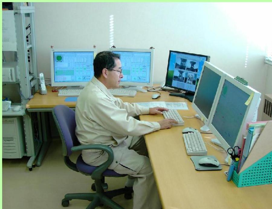
国立天文台水沢に設置されたAOCでの運用の様子。4台のPCからインターネット経由でそれぞれの局を操作できる。また、中央のPC画面(黒)では各局の様子がカメラで表示されている。
