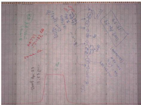
試験用受信機 (6.7 GHz) + パワーメーターにて、Az 固定、EI スキャンにより、太陽からの電波の受信に初めて成功
