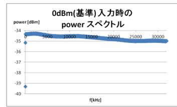
PowerMeter の Scaling Factor を引き、0dBm(基準) 入力時の各チャンネルの power と合わせた周波数に対する残差の割合
