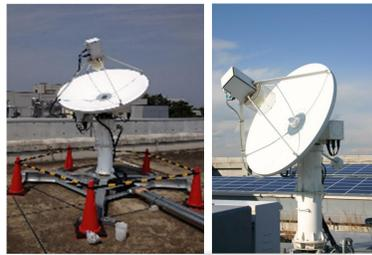
図4 GALA-Vシステムの3つの電波望遠鏡。産総研に設置した1.6m アンテナ(上左)、NICT/小金井本部に設置した1.5m アンテナ(上右)、およびNICT鹿島の34mアンテナ(下)。
