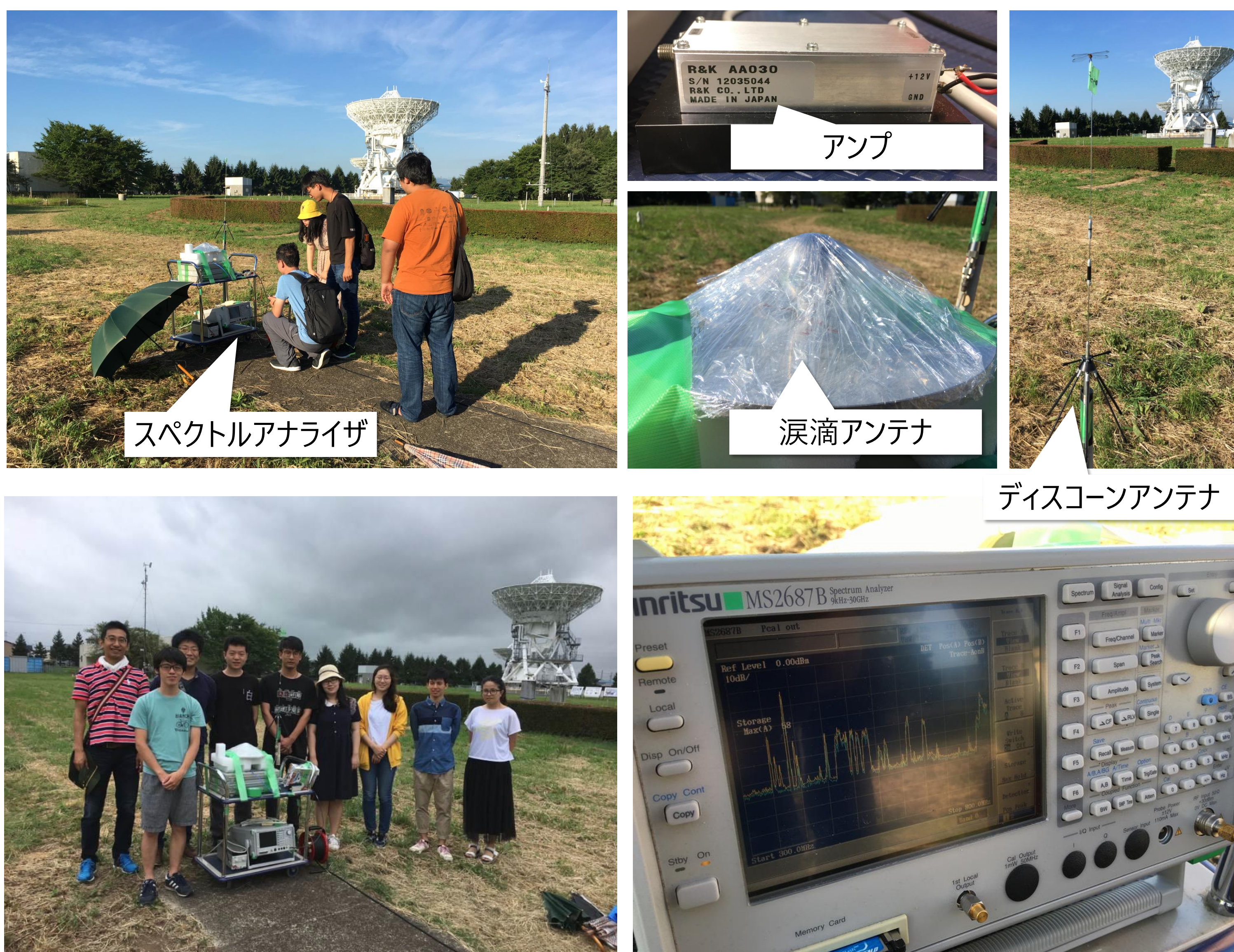
図1 水沢局内における2018年8月23日-24日の測定の様子と測定系。主に中国科学技術大学の学生3人と総研大生1人とともに測定を行った。地上での測定であり、周囲には建物や樹木が多く見通しは良くはない。
